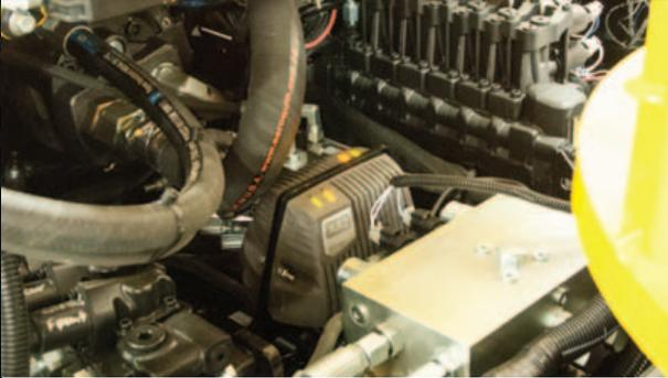
La Mini-Jaraff offre un accès aisé à tous les éléments de l'unité, pour des opérations d'entretien et de maintenance rapides et efficaces. Un faisceau de câblage à code de couleur permet une identification claire de tous les câbles et contribue à la précision du travail d'entretien et de maintenance. La Mini-Jaraff dispose d'outils de diagnostic complets et d'indicateurs à partir de l'écran de contrôle LCD interactif de la machine.
